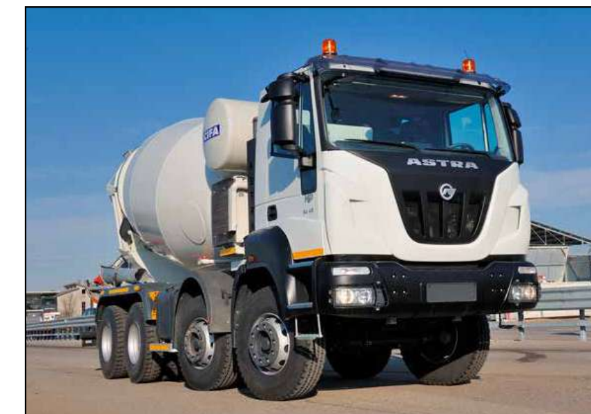
Camiões Betoneira, Mistura de Cimento e Betão Cement Mixer, Concrete / Mixer Pump Trucks
