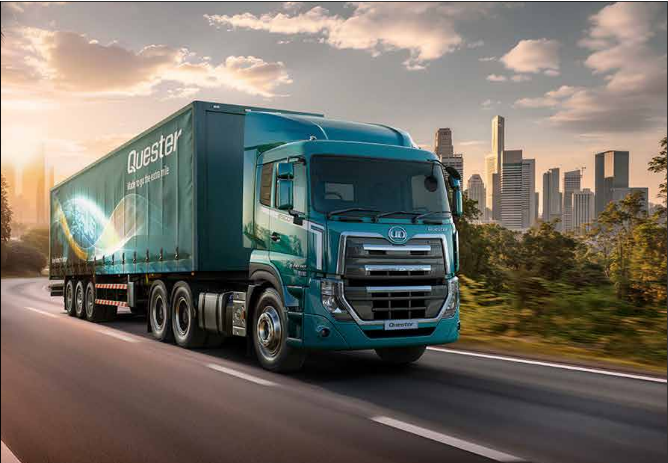
UD Quester Transporte pesado, construção e longa distância | Configurações 4x2, 6x4, 8x4 | Motores GH8E / GH11E com elevado binário Transmissões manual, AMT (ESCOT) ou automática Heavy-duty / Heavy transport, construction and long haul | 4x2, 6x4, 8x4 configurations | GH8E / GH11E engines with high torque | Manual, AMT (ESCOT) or automatic transmissions
